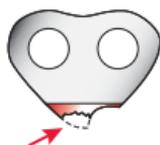
**Solution :** conservez une tension appropriée pour empêcher la chaîne de se faufiler hors du pignon d'entraînement à étoile. Remplacez les maillons-guides ou remplacez entièrement la chaîne si plusieurs maillons-guides sont endommagés.
