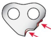
**Solution :** éliminez les dommages des deux côtés des maillons-guides à l'aide d'une lime plate. Affûtez les soies des maillons-guides, tel qu'indiqué par l'illustration en page 24. Utilisez une lime fine pour échancre le départ de la fente au niveau de l'extrémité du guide-chaîne.
