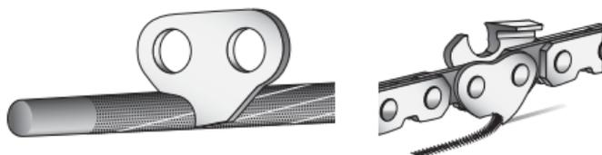
Des soies de maillons-guides pointues facilitent le retrait des copeaux et des débris de la rainure de votre guide-chaîne. Affûtez les soies endommagées pour revenir à la forme d'origine à l'aide d'une lime arrondie.
